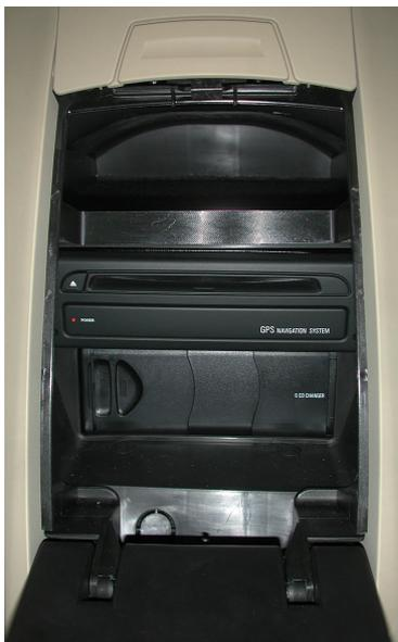
CD 换碟机为 E46 上使用的标准 6 碟 CD 换碟机。
