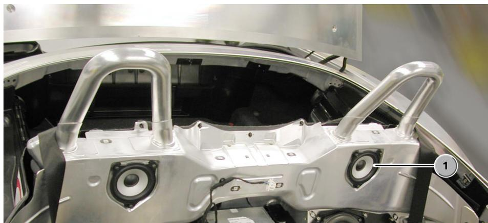
插图 28：E85 座椅后部的中音扬声器
