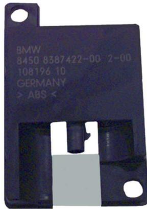
蓝牙天线在 ISM 频带（工业、科学和医学频带）范围内以 2.45 GHz 频率工作。蓝牙天线的结构与早期的 WDCT 天线相同。
