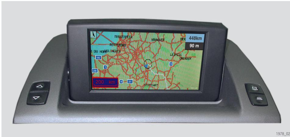
插图 5：E85 带有导航地图的中央信息显示屏
