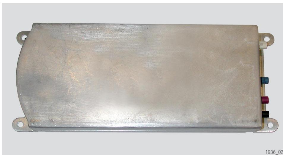
插图 42：远程通信系统控制单元 TCU
