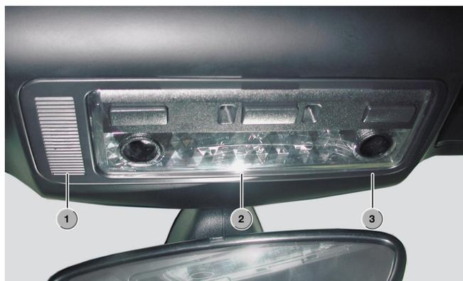
插图 45：E85 免提通话话筒的安装位置
