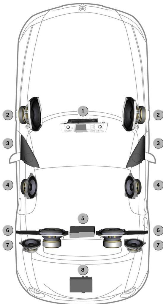
插图 33 : E85 顶级高保真音响系统概览
