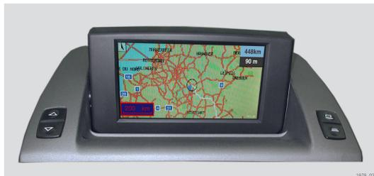
中央信息显示屏是高版本导航系统的显示单元。该显示屏是一个 6.5" 高级 TFT 显示屏，用于显示操作界面和地图。
