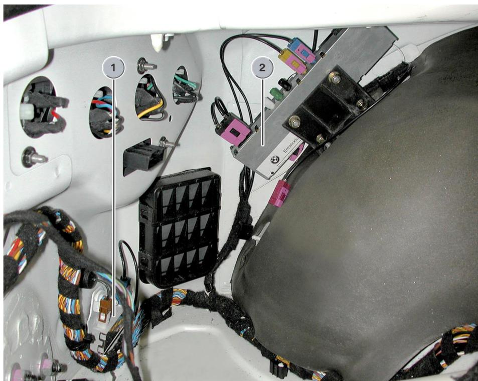
插图 71：E85 天线放大器和天线多相择优装置的安装位置
