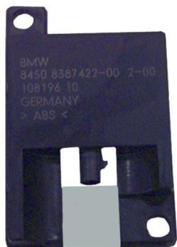
蓝牙天线的工作频率是 2.45 GHz。它的结构与早期的 WDCT 天线(全球数字无绳电话)的结构相同。
