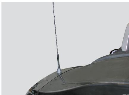
插图 17：E85 棒状天线的安装位置
