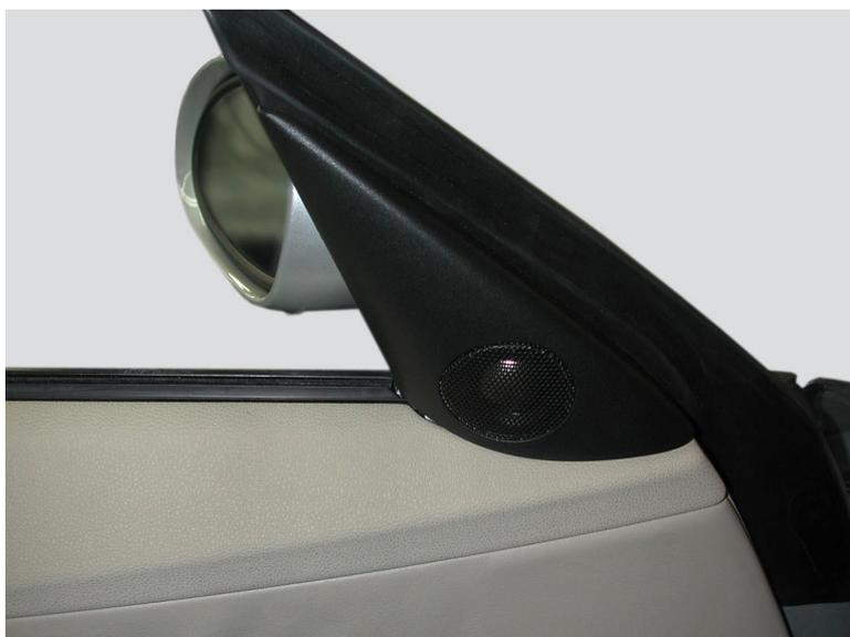
插图 27 : E85 后视镜三角支座内的高音扬声器
