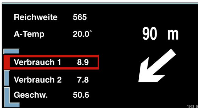
采用分屏显示模式并选择车载计算机功能时，会显示带有指示箭头的导航内容。
