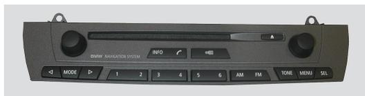
通过右侧旋压式按钮和 CID 操作面板上的菜单按钮可操作 CID 显示屏内的所示功能。
