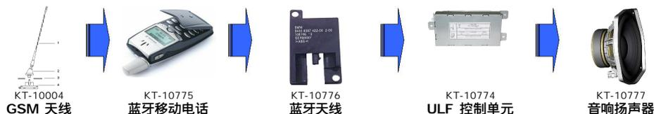
由于车辆装有一个数字式全双工免提通过装置，因此可以同时接听和讲话。用话筒讲话时会通过回波补偿装置防止通话回馈。话筒信号通过一个 NF 导线发送至 ULF 控制单元。在这里对蓝牙模块内接收到的 NF 信号进行加密并通过蓝牙天线发送给移动电话。移动电话通过 GSM 天线发送通话信号。
