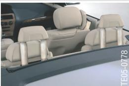
E93 敞篷车拥有一个带翻车保护系统的被动安全系统。发生碰撞事故导致车辆翻车时,翻车保护杆自动移出并与风挡玻璃框架一起为乘员提供足够的生存空间。翻车传感器系统集成在碰撞和安全模块内。通过 ROC 控制单元触发相关执行机构。发生侧面碰撞时,位于座椅靠背内的大容积侧面安全气囊可保护乘员胸部和头部。
