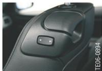
E93 的电动座椅带有后座区登车辅助功能，用于为登车进入后座区提供便利。为此在靠背顶端上装有一个调节开关，以便通过座椅纵向调节功能以两倍的速度前后调节座椅。通过以机械方式使座椅靠背解锁还可以向前翻折靠背，从而为舒适登车提供足够的空间。
