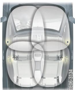
E93 敞篷车防盗报警装置的基本功能和操作与硬顶跑车相同。不同之处仅在于车内监控装置和与车载网络的连接。在此使用微波传感器而不是超声波传感器来进行车内监控。微波传感器可以在折叠式车顶打开时监控车内空间。
