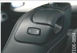
E93 的电动座椅带有后座区登车辅助功能,用于为登车进入后座区提供便利。为此在靠背顶端上装有一个调节开关,以便通过座椅纵向调节功能以两倍的速度前后调节座椅。通过以机械方式使座椅靠背开锁还可以向前翻折靠背,从而为舒适登车提供足够的空间。
