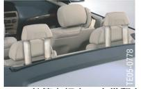
E93 敞篷车拥有一个带翻车保护系统的被动安全系统。发生碰撞事故导致车辆翻车时，翻车保护杆自动移出并与风挡玻璃框架一起为乘员提供足够的生存空间。翻车传感器系统集成在碰撞和安全模块内。通过 ROC 控制单元触发相关执行机构。发生侧面碰撞时，位于座椅靠背内的大容积侧面安全气囊可保护乘员胸部和头部。
