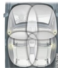
E93 敞篷车防盗报警装置的基本功能和操作与硬顶跑车相同。不同之处仅在于车内监控装置和与车载网络的连接。在此使用微波传感器而不是超声波传感器来进行车内监控。微波传感器可以在折叠式车顶打开时监控车内空间。
