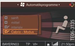
带有 IHKA 的 E93 敞篷车拥有一个附加程序,即敞篷车模式。敞篷车模式有一个用于折叠式车顶敞开状态下行驶时的通风专用设置。系统根据光照强度、车速和车外温度调节用于控制通风的参数。因此确保为乘员提供最佳的车内气候舒适性。
