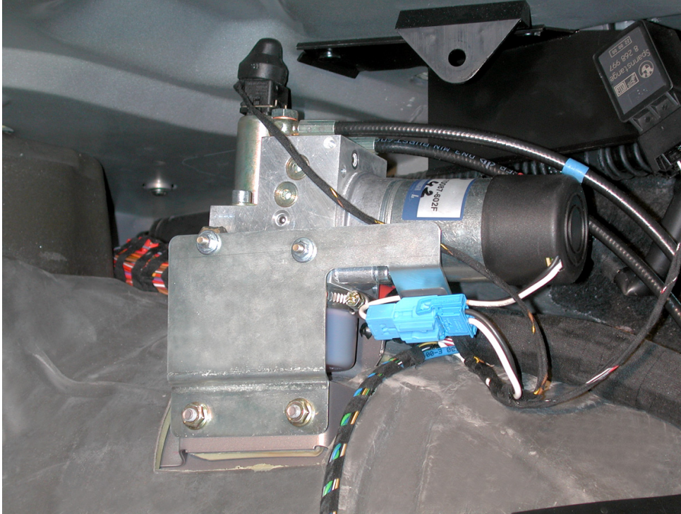
图 87：行李箱内右侧后行李箱盖提升装置液压单元安装位置
