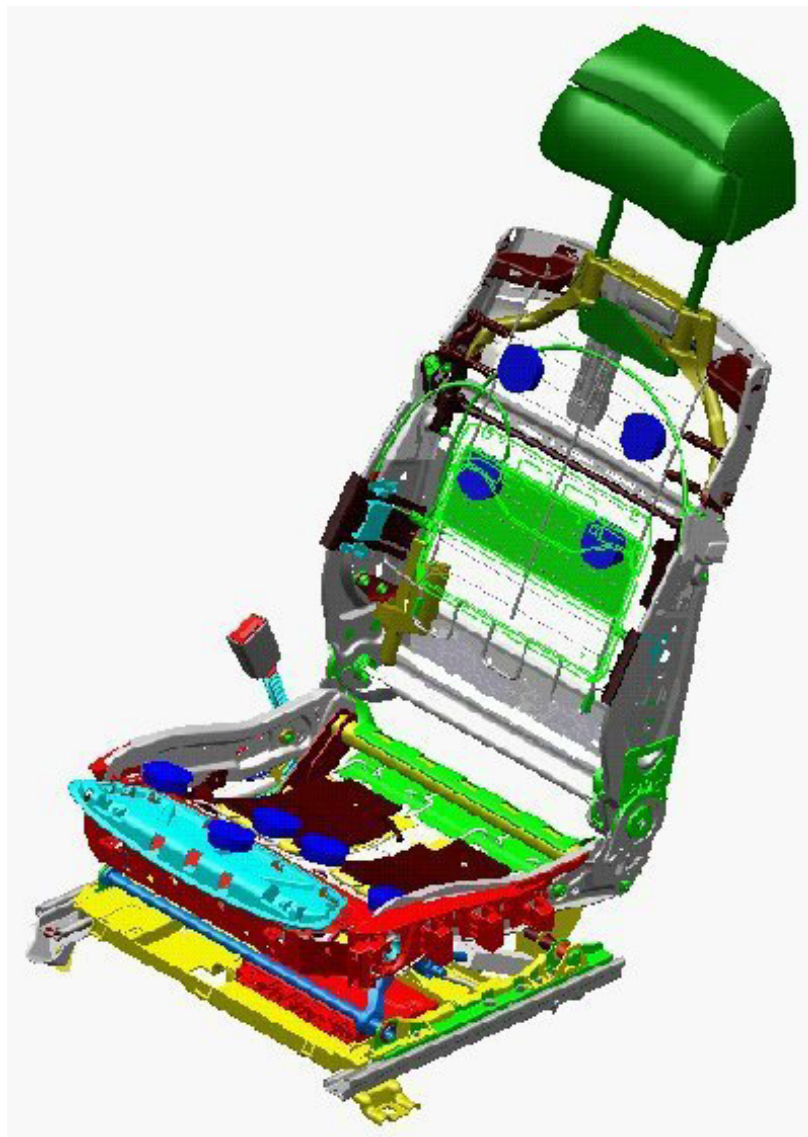
图 50: 舒适型座椅: 深蓝色的圆表示风扇马达。
