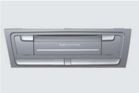
奥迪 A4、A5 或 Q5 中的 MMI Navigation plus 的控制单元 J794 435_014
