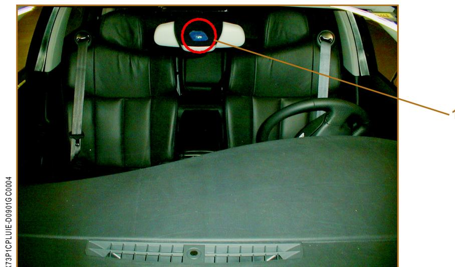
Un nouveau capteur (1) de pluie et de lumière équipe RENAULT Vel Satis. Il analyse la quantité d'eau sur le pare-brise pour mettre en fonction les essuie-vitres avant de façon automatique. Il détermine également la vitesse d'essuyage à adopter en fonction de la quantité d'eau présente.
