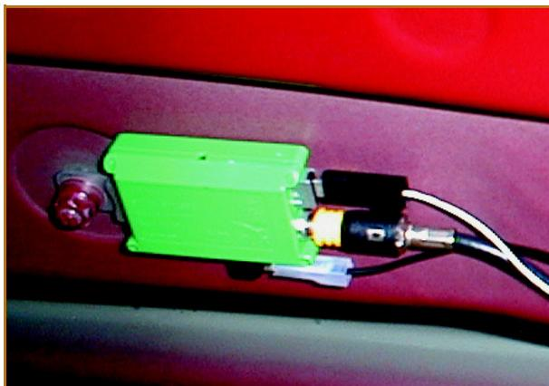
L'antenne radio est moulée dans le hayon. Son amplificateur se situe en partie centrale arrière, sous la garniture du pavillon. Il est relié à l'unité centrale de communication (avec l'équipement Carminat), puis à l'autoradio.
