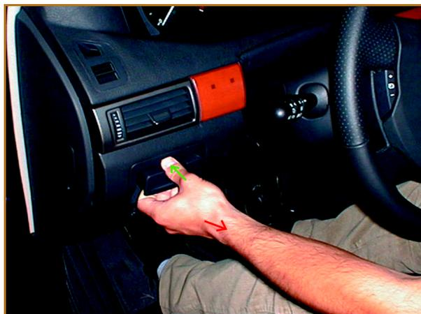
La palette de commande permet le serrage et le desserrage manuels du système.
