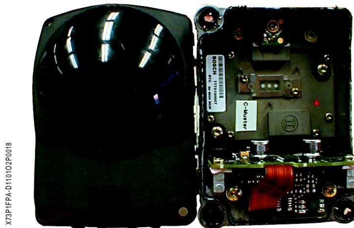
Il permet la détection d'objets mobiles en avant du véhicule, pour en déduire :
