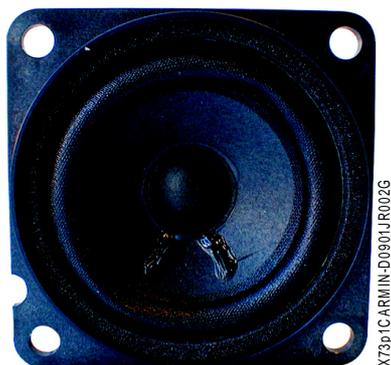
Cet haut-parleur se situe à proximité du volant. Il est également utilisé par la SYNthèse de la Parole (SYP). Si le véhicule possède un équipement main-libre (téléphone), cet haut-parleur est également utilisé par le téléphone. Dans ce cas, il est remplacé par un haut-parleur bi-enroulement.
