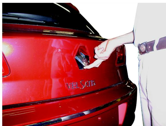
L'utilisateur pose le hayon sur sa serrure, la gâche électrique assure le verrouillage complet du hayon.
