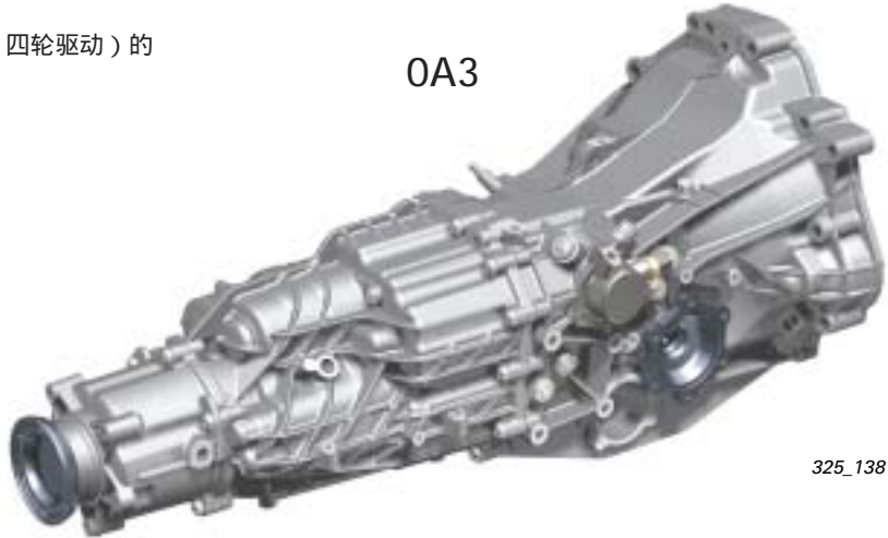
0A3 变速器与3.0 l-V6-TDI-CR 发动机配合使用。
