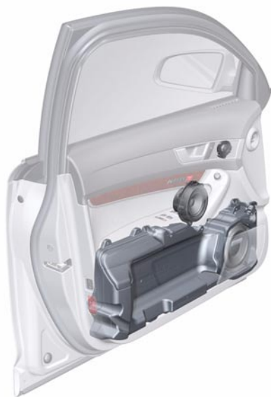
Audi A6 '05 前车门上的超低音扬声器和扬声器的安装位置
