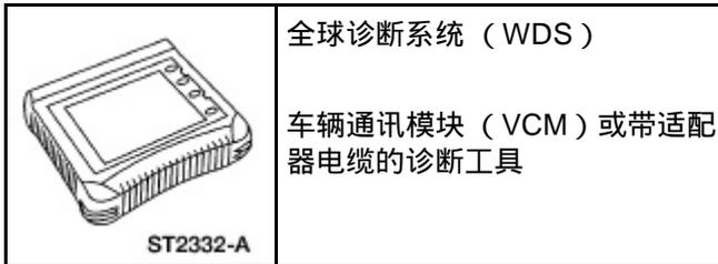
注意：备用钥匙编程开关是诊断工具的1个可编程开关，可以启用/禁用备用钥匙编程程序。参见车主手册或 [本章节中使用2把编程钥匙进行钥匙编程的内容](#)。这个可编程开关对那些不想让驾驶员对备用钥匙进行编程的用户提供了便利。
