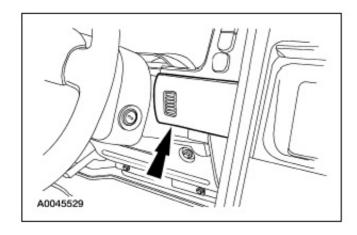
2. 断开吸气管和车内温度和湿度传感器电气接头。
