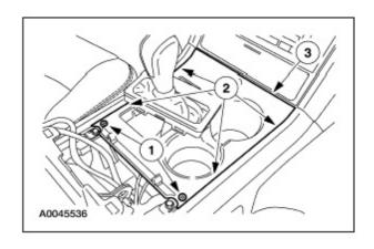
5. 断开电气接头,拆卸螺钉。
