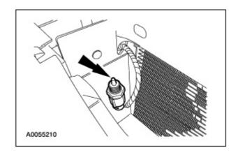
3. 断开电气接头,拆下环境温度传感器。
