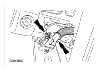
3. 拆卸螺钉和车内温度和湿度传感器。
