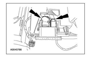
3. 拆卸螺钉和车内温度传感器。
