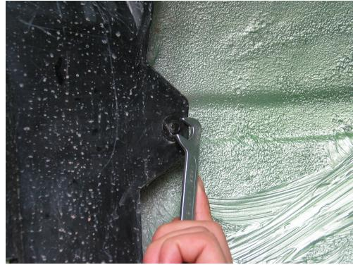
2、利用起子和夹扣拆卸工具，拆下三个夹扣，并取下护板
