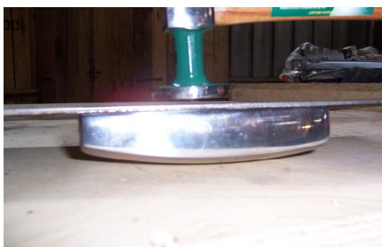
② 手锤不在垫铁上方敲击。这种锤击方法是将垫铁托于金属板凹陷最低处的下面，用手锤敲击附近的高处。
