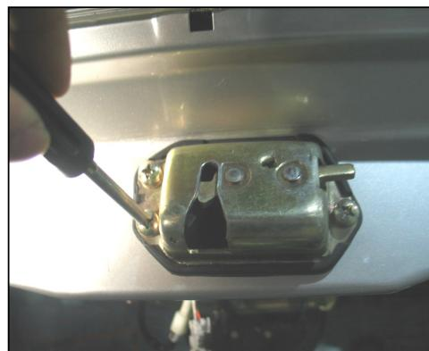
2、松开 3 颗固定螺栓向外移出锁并分离电机线
