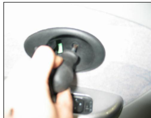
3、拆下门内饰板上的 4 颗固定螺钉：
