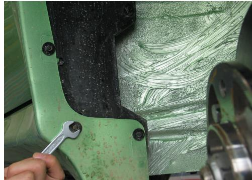
2、松开固定螺钉，利用夹扣拆卸工具拆下夹扣
