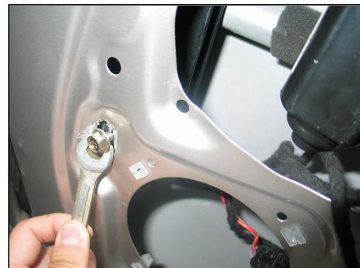
5、松开玻璃升降器与玻璃托架的 2 个固定螺钉
