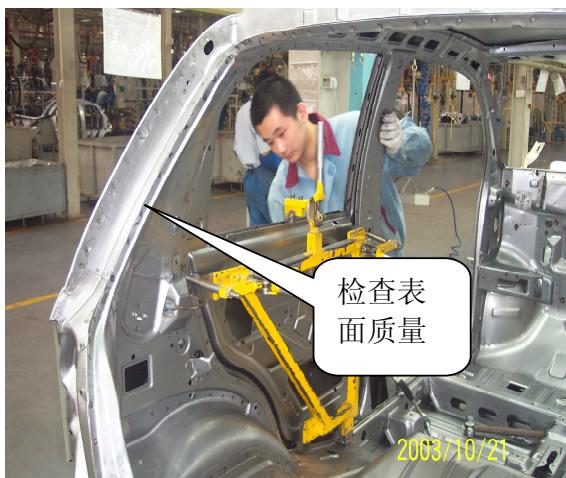
(2) 用 4mm 的塞铁和吸铁在图示位置放好，塞铁为控制间隙大小；吸铁控制平度。
