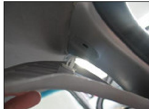
3、用十字螺丝刀，松开驾驶侧上的遮阳板上的固定螺钉
