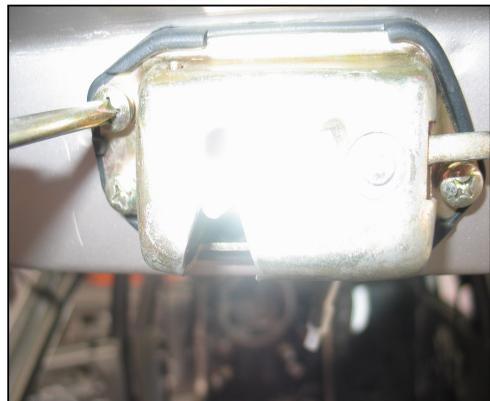
2、脱开后行李箱钥匙开关上的连接杆
