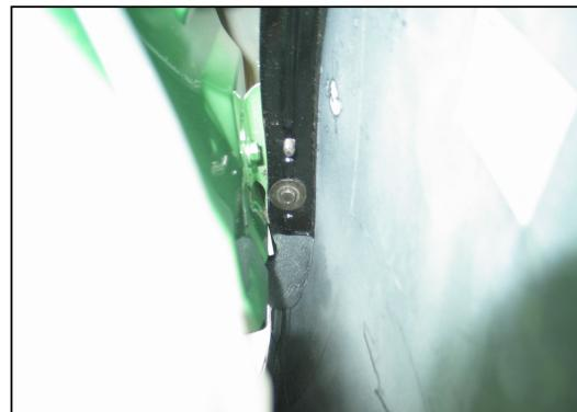
2、利用起子和夹扣拆卸工具拆下七个夹扣。
