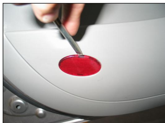
2、拆下插头，取出前车门室内灯总成
