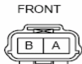
ABS 轮速传感器一侧线束连接器
