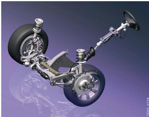
带齿条齿轮式转向系统的前桥
