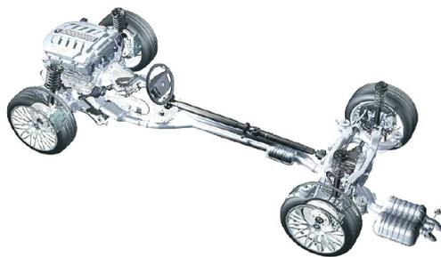
如果车辆有四轮驱动系统，则在变速箱后附加一个分动器，从分动器各有一根传动轴分别通往后驱动桥和前驱动桥。在主减速器中力流通过驱动轴分流到各车轮上。
