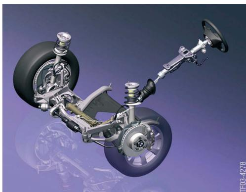
底盘的性能通过车轮位置实现。车轮位置描述车轮相对车身和车道的几何位置。这个位置可通过不同的几何参数确定。这些参数的一部分可在车轴测量过程中直接确定。其它参数由转向运动时的运动学关系确定。车轮位置对下列情况具有决定意义：
