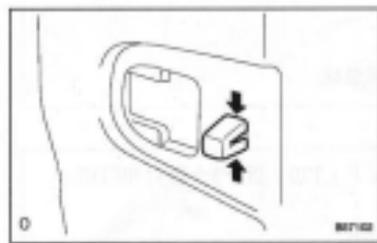
(b) 用钳子松开夹子，如图所示，拆下外部把手框架。
