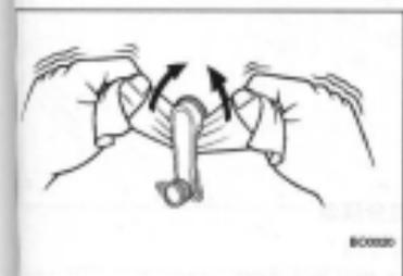
2. 拆下后门窗调节器把手总成 (无电动车窗)
