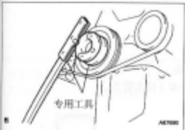
46. 拆下驱动盘和齿圈分总成 (自动传动桥)
