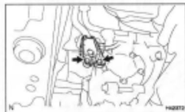
6. 拆下右前空气囊传感器
