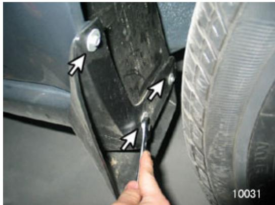
2、松开后轮挡泥板的两颗固定螺钉
