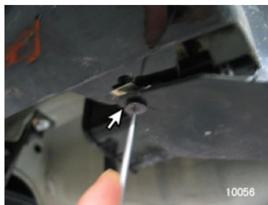
3、打开油箱盖，用起子压出加油管
