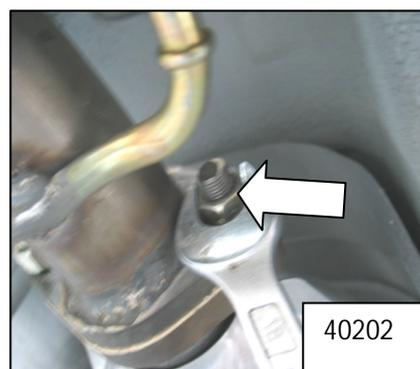
松开前端排气管与三元催化器的固定螺栓，并松开前氧传感器插头，取下排气管
