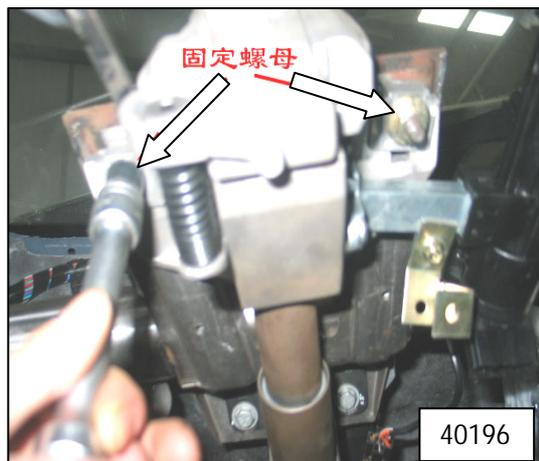
放下转向柱，向后拉出转向柱
