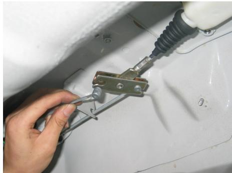
5、松开左右拉线上的 8 颗固定螺栓
