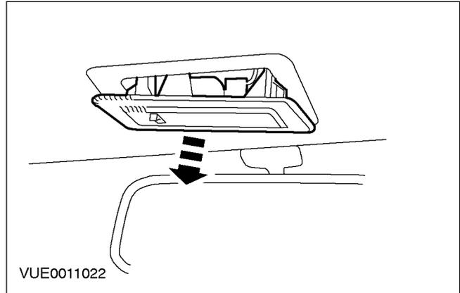
7. 断开电路连接部分，卸下室内灯。(前室内灯)。
