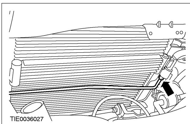
4. 拆下变速器油冷却器。
