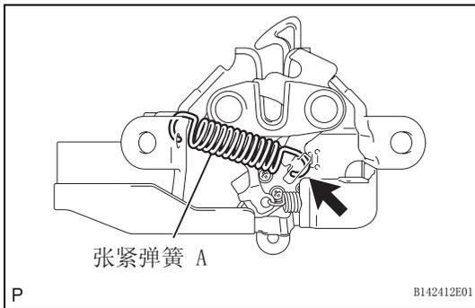
3. 安装发动机盖锁张紧弹簧 A
