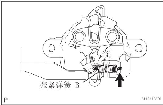
6. 拆卸发动机盖锁扣张紧弹簧 B
