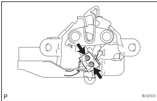
7. 拆卸发动机盖控灯开关
