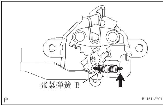
2. 安装发动机盖锁扣张紧弹簧 B
