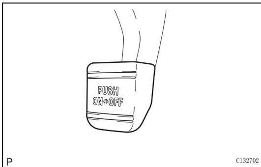
(a) 将驻车踏板衬块安装到驻车制动踏板总成上。
