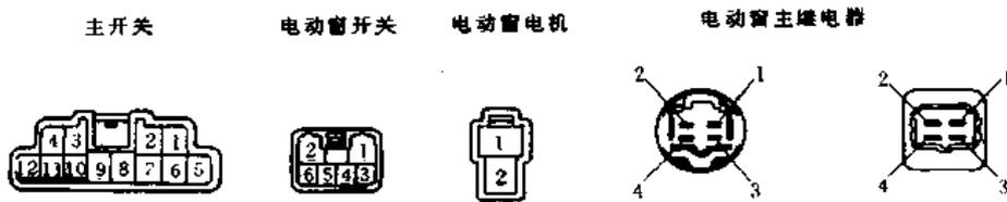
图 10-22 电动门窗控制系统电路图和连接器图
