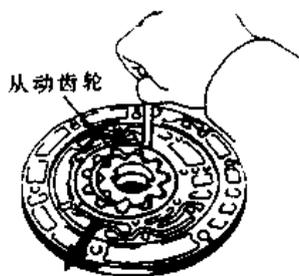
图 3-43 从动齿轮与泵体间隙的检查
