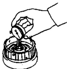
图 3-69 前行星齿轮齿圈衬套的检查
