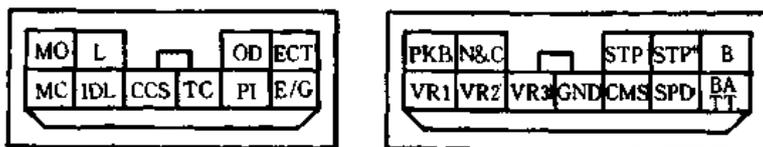
图 6-3 巡航控制系统 ECU 端子图
