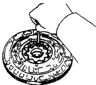
图 3-44 从动齿轮齿顶间隙的检查
