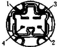
图 6-11 停车灯开关连接器
