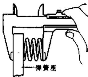
图 3-54 O/D 直接挡离合器回位弹簧的检查
