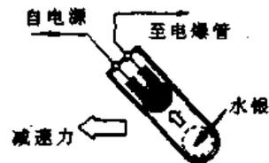
图 5-4 安全传感器工作示意图
