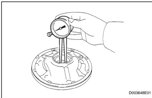
**3. INSPECT FRONT OIL PUMP AND GEAR BODY SUB-ASSEMBLY**
