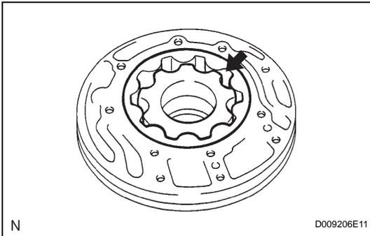
6. **REMOVE FRONT OIL PUMP DRIVEN GEAR**
