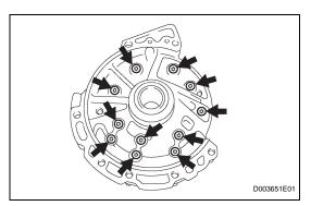
5. REMOVE FRONT OIL PUMP DRIVE GEAR
