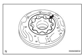
6. REMOVE FRONT OIL PUMP DRIVEN GEAR
