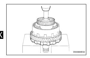
(d) Using a press, press in the parking lock gear.
