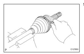
(d) Using a snap ring expander, remove the shaft snap ring.
