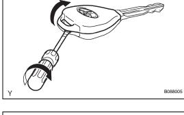
2. REMOVE DOOR CONTROL TRANSMITTER MODULE
