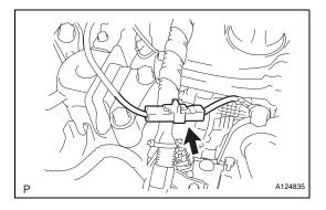
(d) Connect the ground cable connector.
