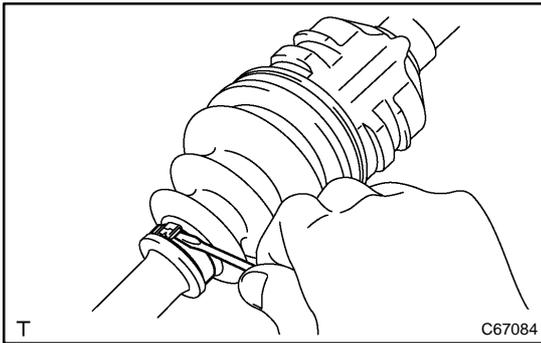
**13. REMOVE FRONT AXLE INBOARD JOINT BOOT LH CLAMP**
