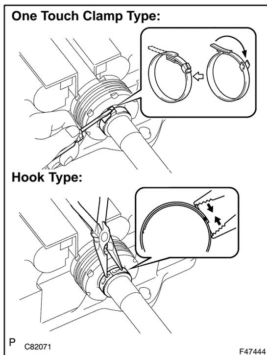
**31. INSTALL DRIVE SHAFT DAMPER SETTING CLAMP**
