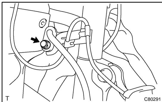
**42. INSTALL SPEED SENSOR FRONT LH**
