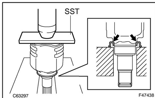
**24. INSTALL FRONT DRIVE SHAFT DUST COVER LH**
