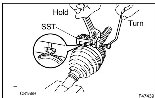
**28. INSTALL FRONT AXLE OUTBOARD JOINT BOOT LH NO.2 CLAMP**
