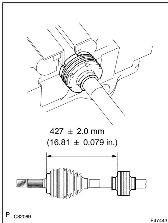
**30. INSTALL FRONT DRIVE SHAFT DAMPER RH**
