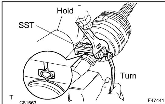
**29. INSTALL FRONT AXLE OUTBOARD JOINT BOOT LH CLAMP**
