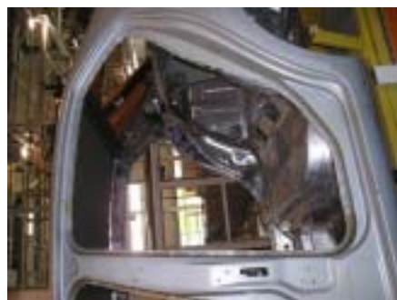
车门侧围BC柱激光焊缝
