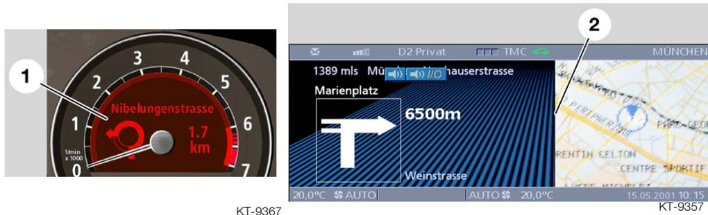
图 46: 在组合仪表和控制显示中的导航指示
