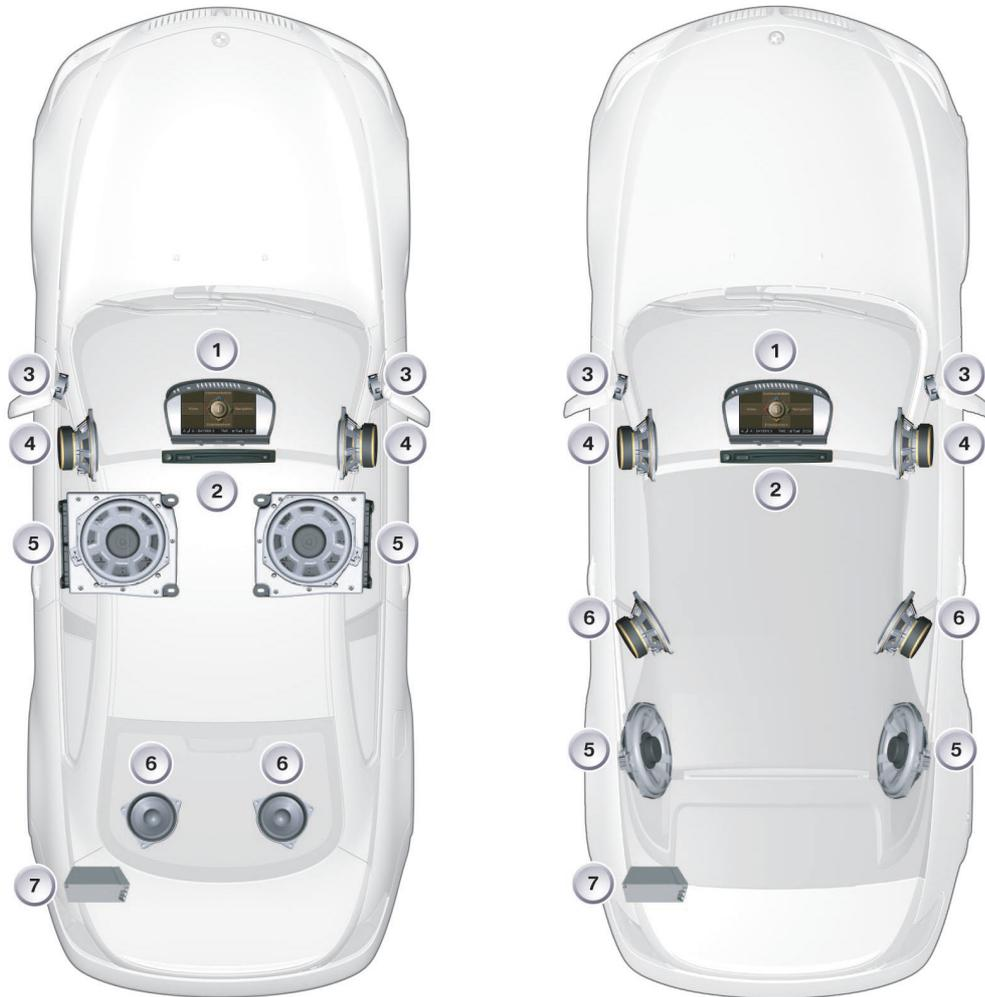
21 - E63 (左侧) / E64 (右侧) 高保真音响系统的安装位置
