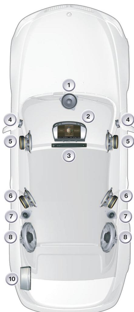
22 - E63 (左侧) / E64 (右侧) 顶级高保真音响系统的安装位置
