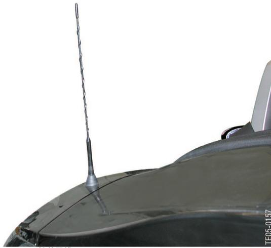
在 E85 上 FM 天线多相择优装置上接有两根天线，即棒状天线和保险杠内的天线。天线多相择优装置通过这些天线产生另外两个虚拟天线信号。
