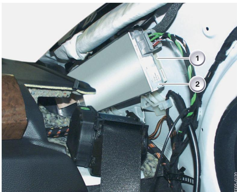
8 - 左侧 C 柱天线调谐器的安装位置
