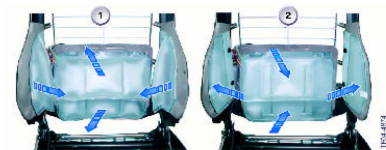
5 - 腰部支撑调节装置和靠背宽度调节装置，最大(1)/最小(2)
