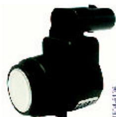
是否以视觉方式显示距离信号取决于多功能音频系统控制器和车辆通信计算机。驻车距离监控装置使用探测范围约 250 cm 的转换器（超声波传感器）。
