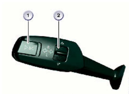
7 - 远光灯和转向信号灯开关组合开关
