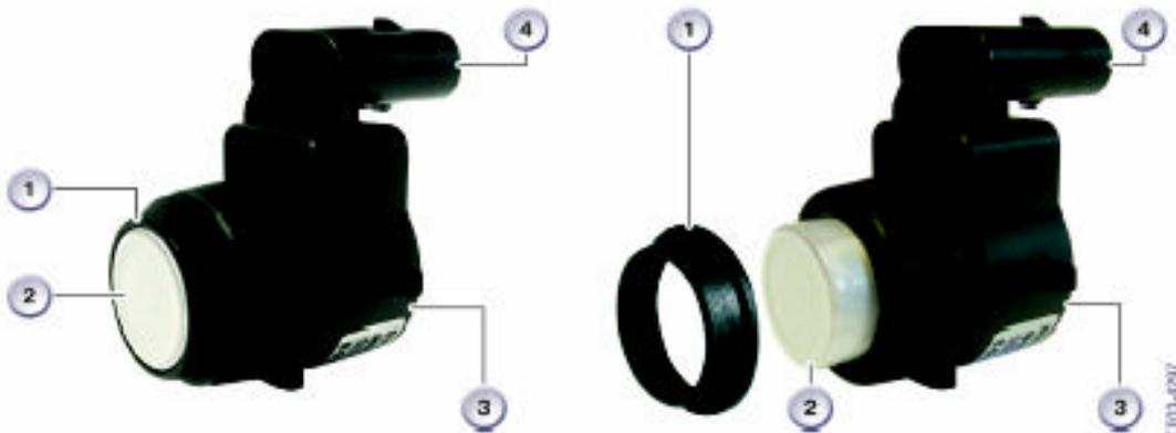
1 - 左图：装有环的传感器。右图：传感器和已经取下的环。
