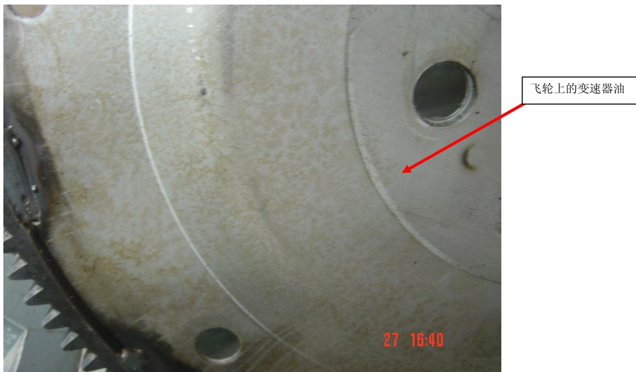
至于淡黄色的液体，那是发动机飞轮的润滑油，车辆高速行驶时，飞轮表面的润滑油在高温下挥发，也会从发动机与变速器连接处流下来，以至表现为发动机漏油。
