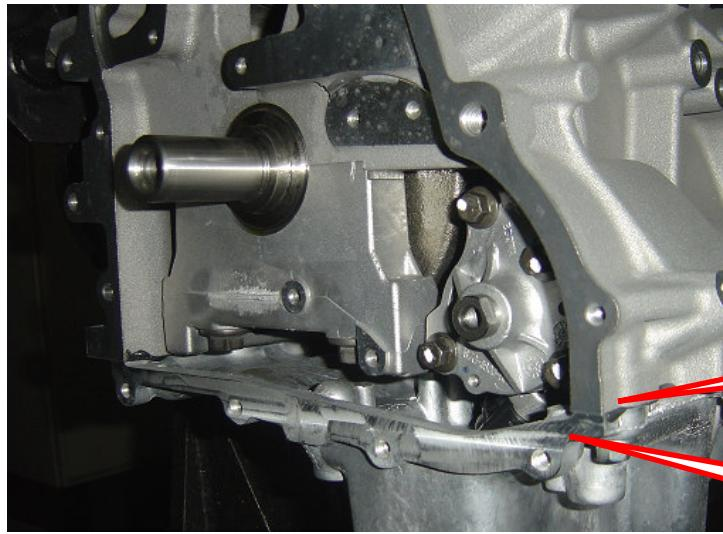
3、安装离合器时为保证离合器，变速器输入轴与曲轴同心，必须使用工装（见图片），否则可能导致变速器安装困难，损伤变速器输入轴与摩擦片花键
