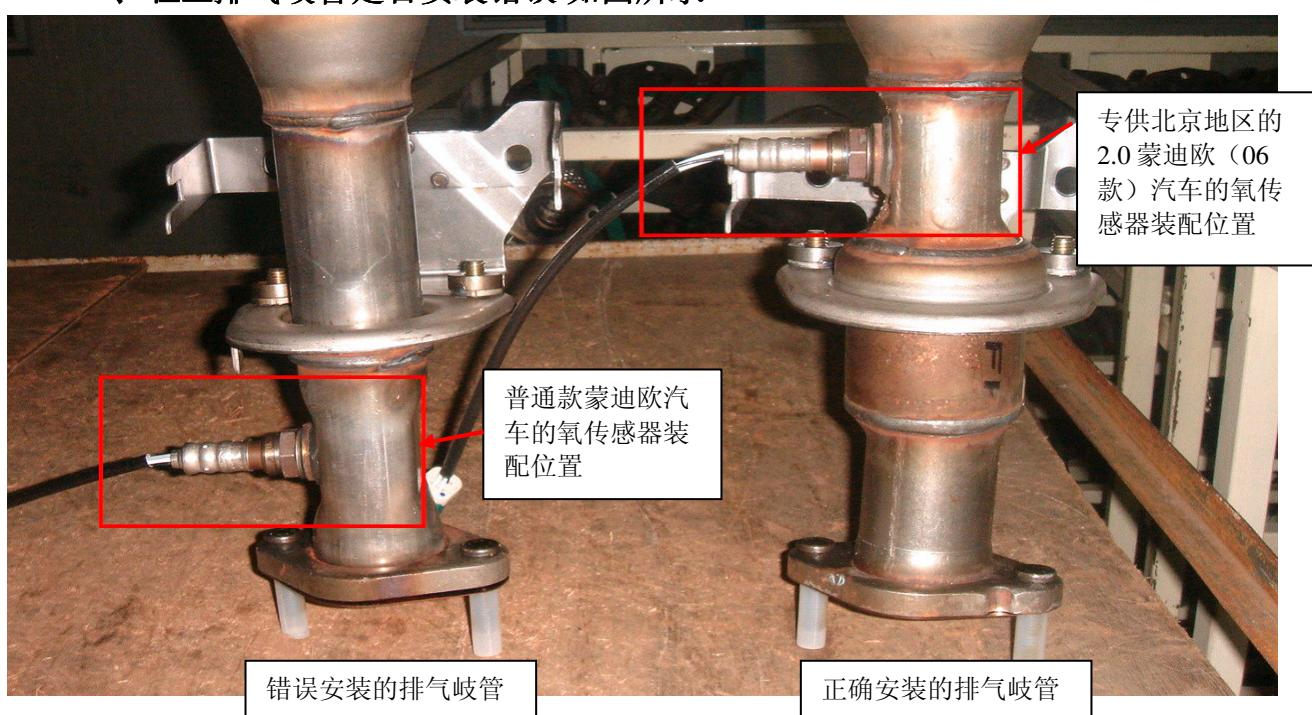
如果检查排气岐管安装正确，本次检查工作到此结束。如果检查发现排气岐管安装错误，继续下一步骤；
