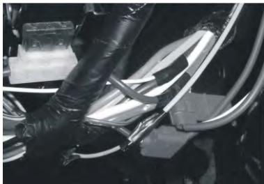
+B粗粉红；ACC：粗蓝，断电器接在粗红线上
