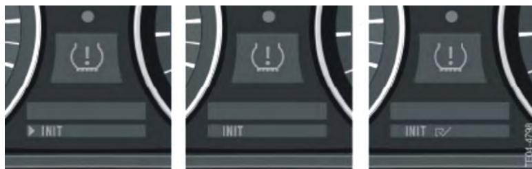
图1 轮胎失压显示RPA 初始化
