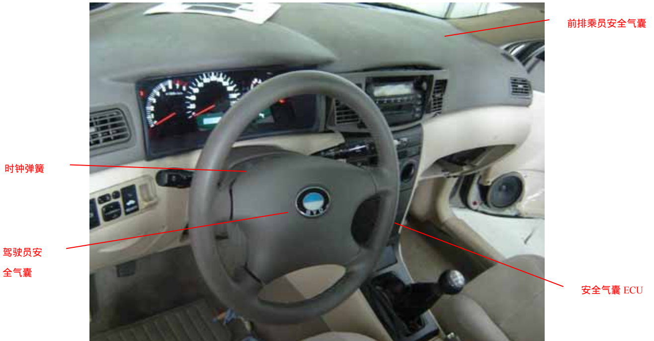
图 1 安全气囊系统部件位置
