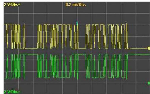
K-CAN 的无故障示波图
