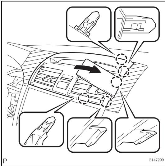
(b) 用嵌条拆卸工具，如图所示脱开 5 个定位爪。
