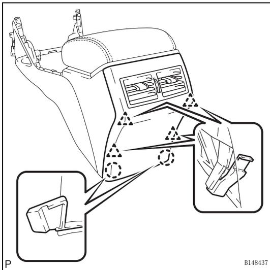
2. 安装后中央控制台端板分总成
