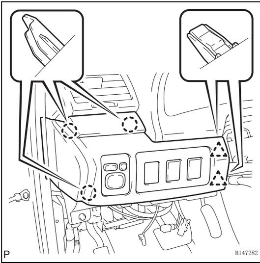
(b) 接合 3 个定位爪和 2 个卡扣来安装 1 号仪表板分总成。
