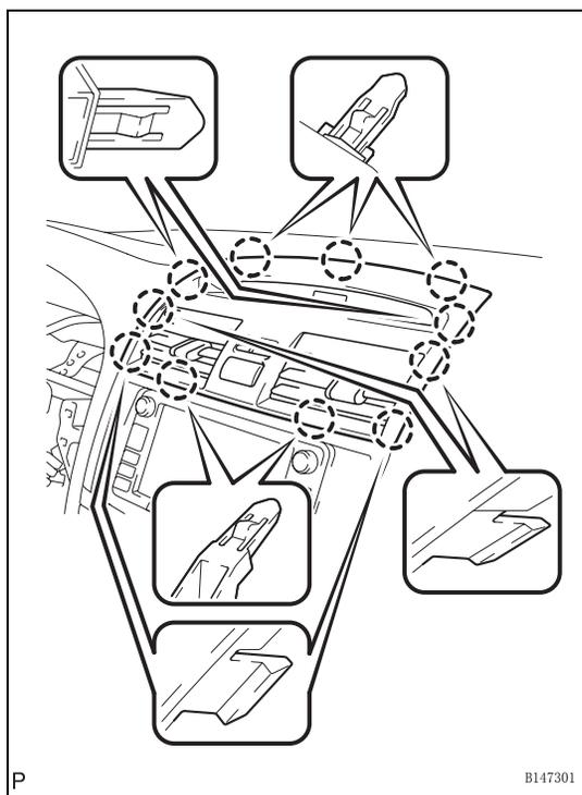
(b) 接合 11 个卡扣并安装仪表板 2 号调节器总成。
