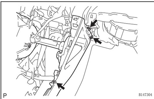
(c) 拆下 3 个螺钉 <F>。
