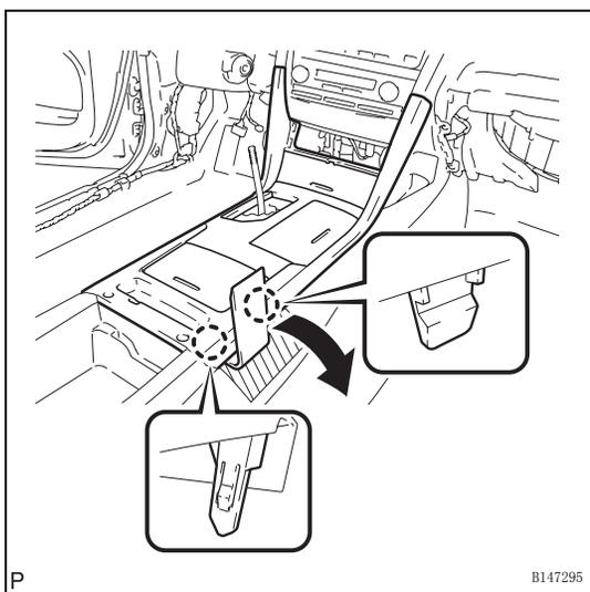
(d) 用嵌条拆卸工具，如图所示脱开 2 个定位爪。
