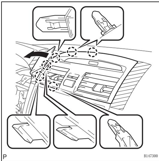
(c) 用嵌条拆卸工具，如图所示脱开 6 个定位爪。
