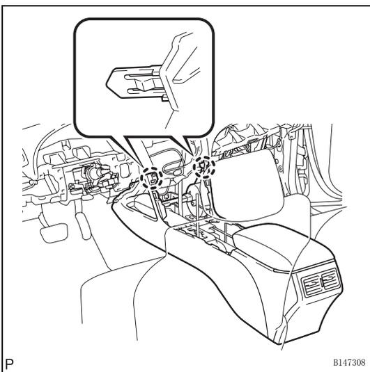
(e) 脱开 2 个定位爪并拆下中央控制台总成。
