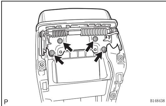
2. 拆卸中央控制台箱门分总成
