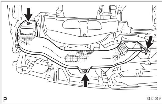
4. 拆卸 1 号加热器至调节器管道
