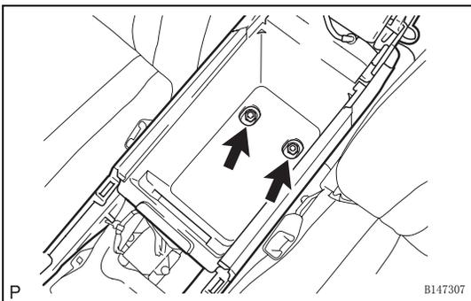
(d) 拆下 2 个螺栓 <G>。
