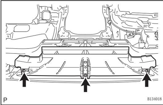
3. 拆卸除霜器喷嘴总成
