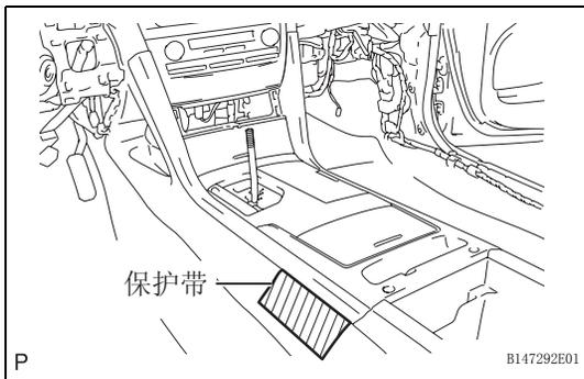
24. 拆卸中央控制台上板分总成
