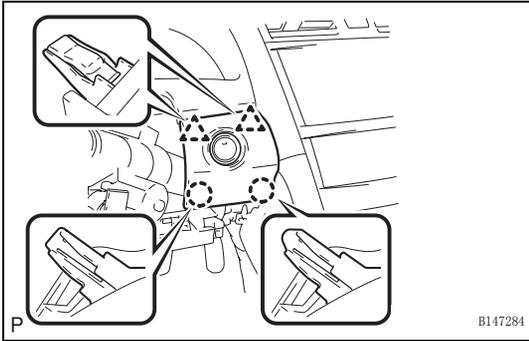
(b) 接合 2 个定位爪和 2 个卡扣来安装仪表板下饰板。
