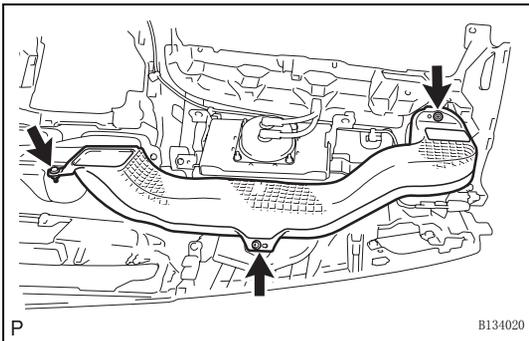
5. 拆卸 3 号加热器至调节器管道
