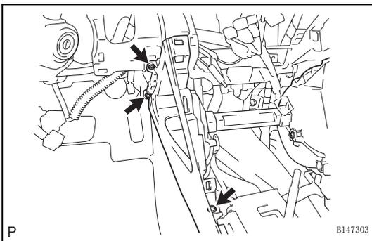
(d) 用 3 个螺钉安装中央控制台总成。
