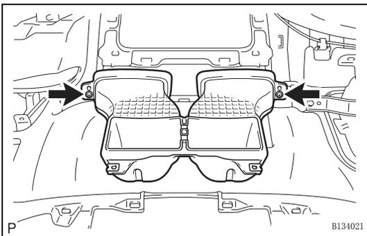
6. 拆卸 2 号加热器至调节器管道
