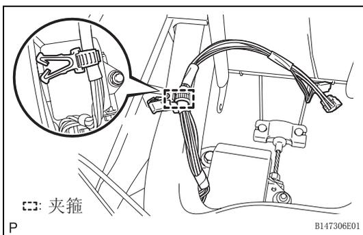
29. 拆卸中央控制台总成
