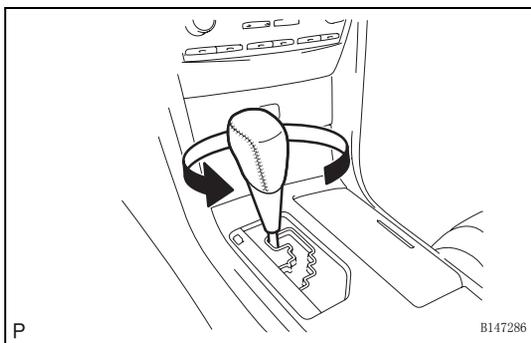
22. 拆卸换挡杆捏手分总成
