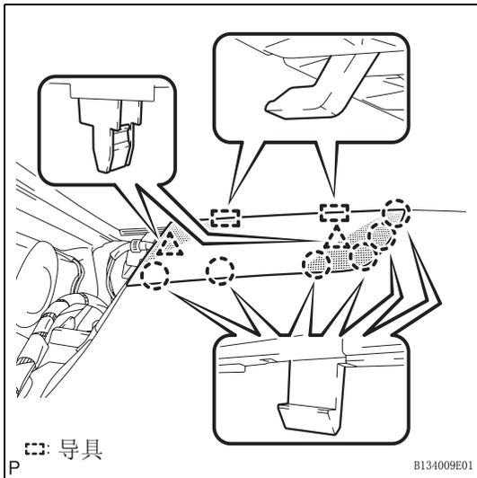
**33. 拆卸仪表板 1 号扬声器面板分总成**
