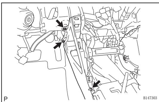
(d) 用 3 个螺钉 <F> 安装中央控制台总成。
