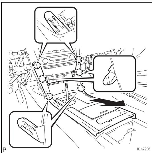
(e) 如图所示，脱开 6 个定位爪，并拆下中央控制台上板分总成。
