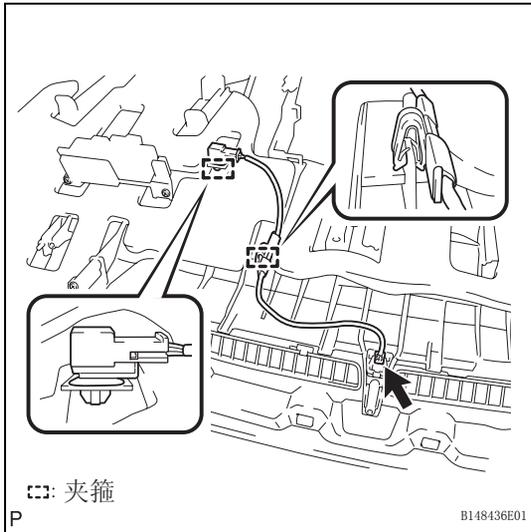
9. 拆卸 3 号仪表板导线
