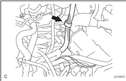
(c) 将导线连接到发动机室接线盒。然后用螺母和 3 个连接器将其安装。
