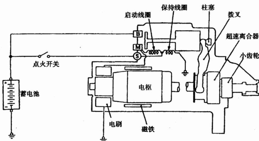
图 42—2—1 启动系统电路图
