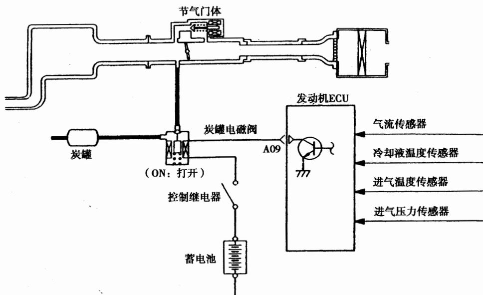
图 42—1—2 炭罐电磁阀电路图
