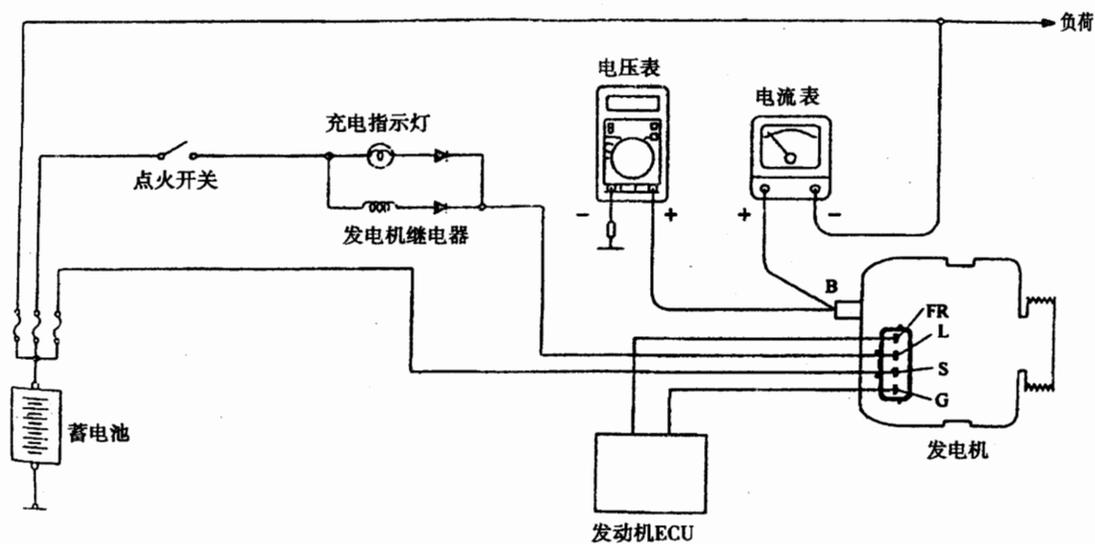
图 42—2—2 充电系统电路图
