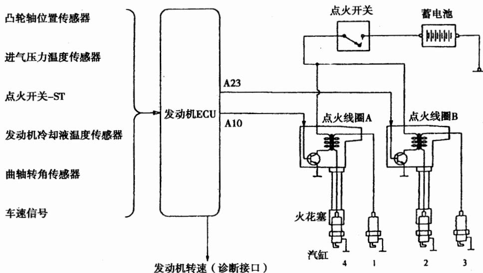
图 42—1—1 点火系统电路图
