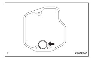
(d) Install the oil strainer with the 3 bolts.
