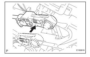
(d) Connect the control cable to the shift lever.
