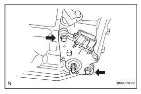
(d) Remove the 2 bolts and pull out the switch.
