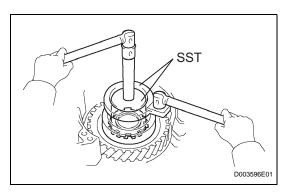
(b) Using SST, remove the nut. SST 09387-00030, 09387-00080
