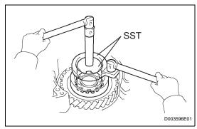
(b) Using SST, remove the nut. **SST 09387-00030**, **09387-00080**
