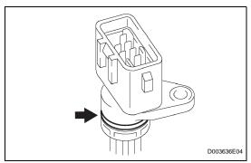
(d) Remove the O-ring from the transaxle wire.
