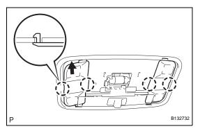
(d) Attach the 4 claws to install the 2 covers.
