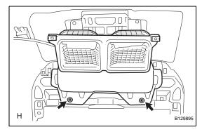
7. INSTALL NO. 2 HEATER TO REGISTER DUCT
