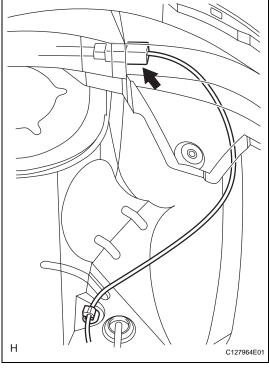
(d) Connect the sensor connector.
